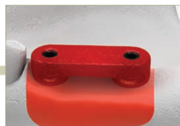
Изготовление позиционирующего шаблона
