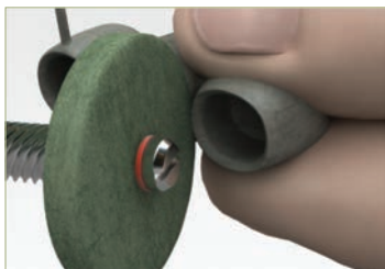
Шлифовка наружного края каркаса полировочным диском
